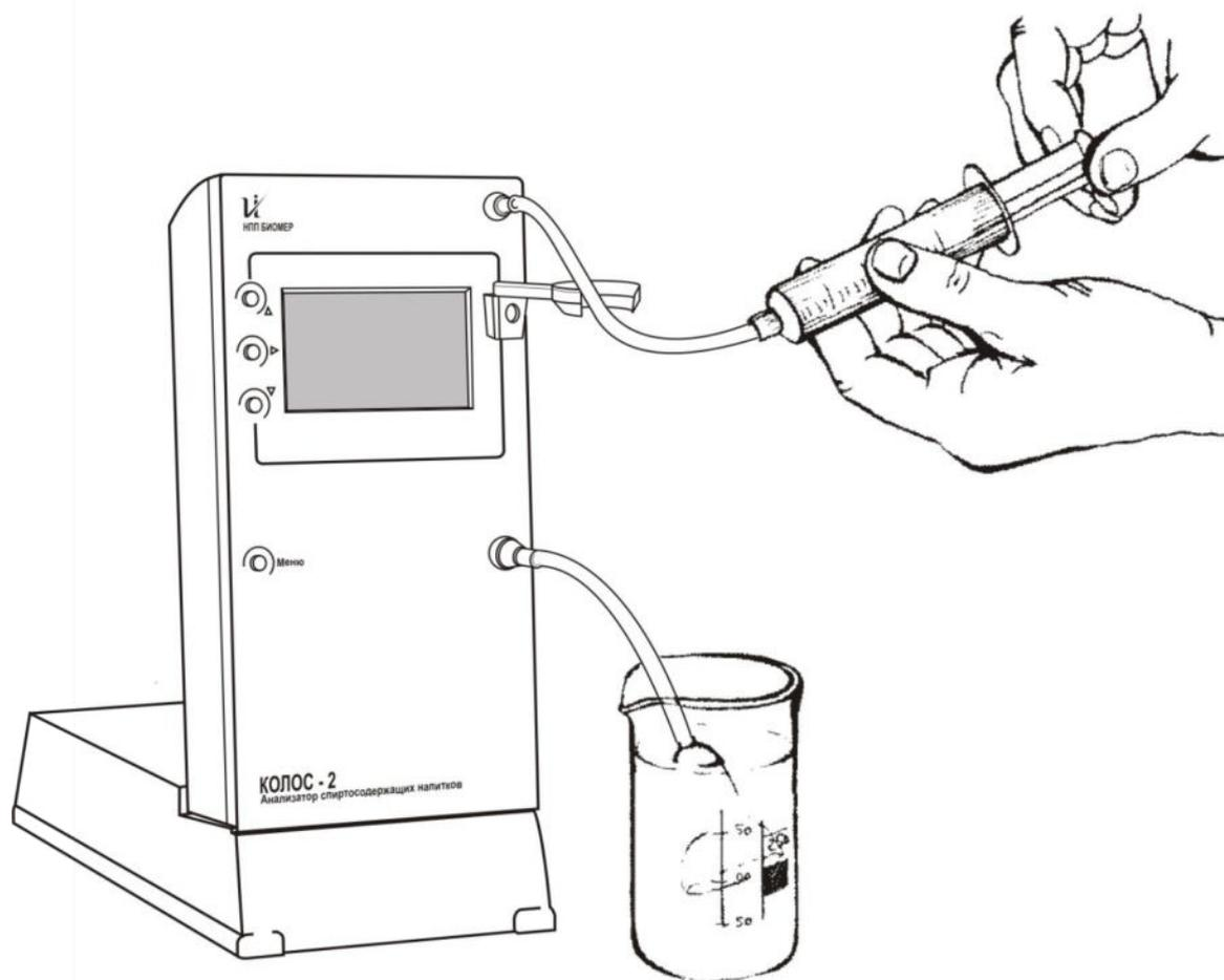
Рисунок 3.1 - Промывка анализатора
