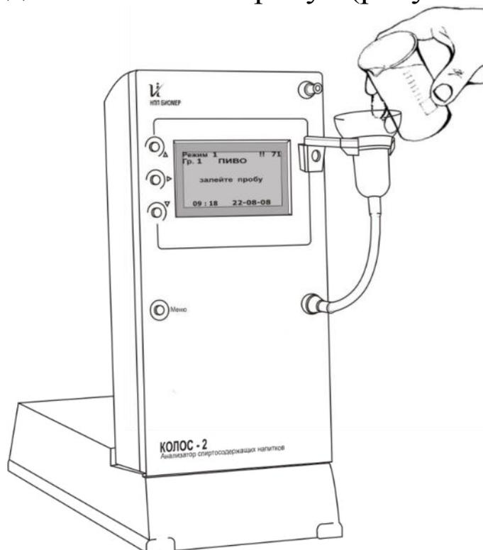
Рисунок 2.5 – Заливка пробы для измерения
